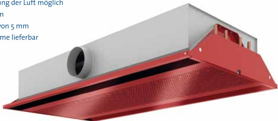
Die Einheit wurde als Einsatzmodul für Systemdecken mit einzelnen T-Trägern oder Bandrasterprofilen mit einem Modulmaß von 600 mm entworfen. Die Einheit kann auch als Zwischenelement in Kassettendecken, verborgenen Deckensystemen oder festen Decken eingesetzt werden. Jede Länge zwischen 1195 und 2995 mm in Schritten von 5 mm ist lieferbar.
