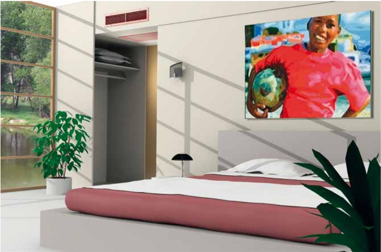
Der OKNB (Hoteleinheit) wird völlig unsichtbar montiert und bietet eine ästhetisch schöne Lösung. Die Wahlmöglichkeit unter den verschiedenen Einblasgittern und der Farbe werden der Stimmung im Hotelzimmer zugute kommen. Durch den niedrigen Schallpegel der Einheit wird die Behaglichkeit im Zimmer nicht nachteilig beeinflusst.
