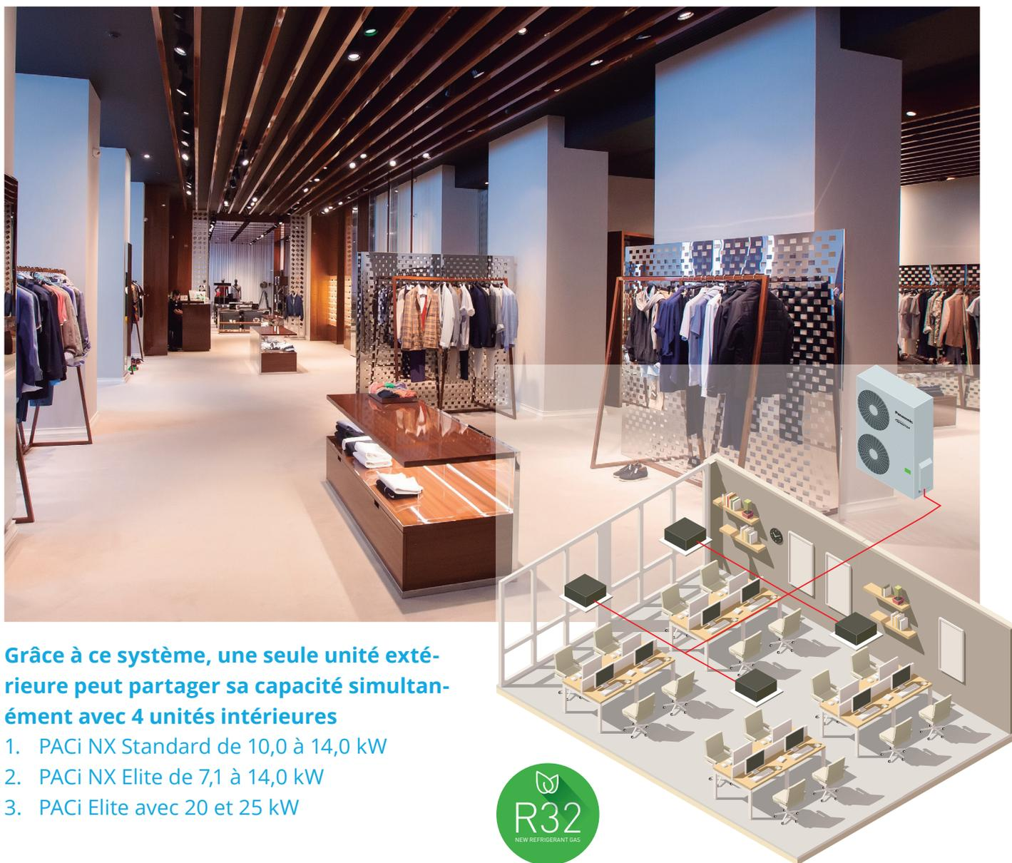
Grâce à ce système, une seule unité extérieure peut partager sa capacité simultanément avec 4 unités intérieures
